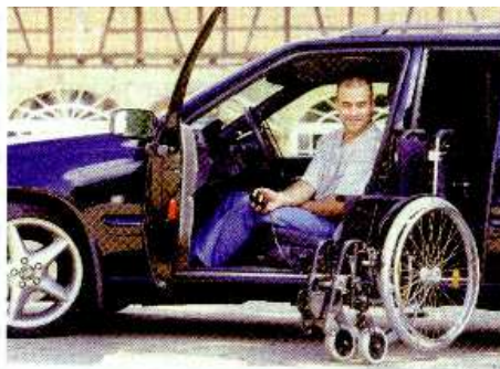
VERLADESYSTEM „HAAG ROLLIFIX 2“ MIT SCHWENKTÜR
