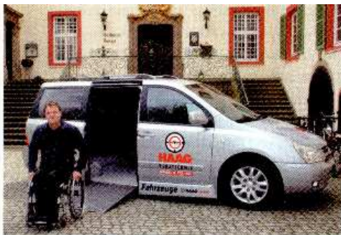
KIA CARNIVAL MIT RAHMENSTIEFERLEGUNG, UNTERFLURRAMPE UND ABSENKUNG
